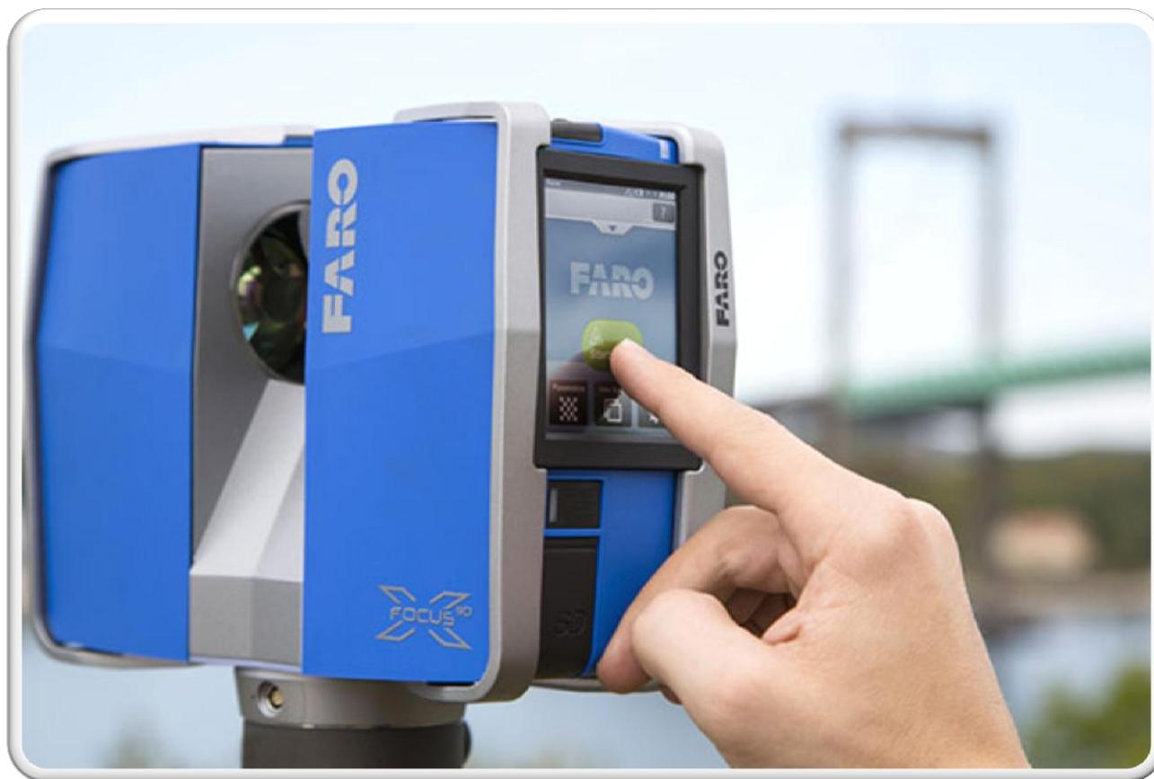
**Принцип работы** лазерного сканера Focus3D основан на подаче инфракрасного лазерного луча в центр вращающегося зеркала. Зеркало отражает лазерный луч, перемещая его в сканируемой среде; рассеянный от окружающих объектов свет затем попадает обратно в сканер.
