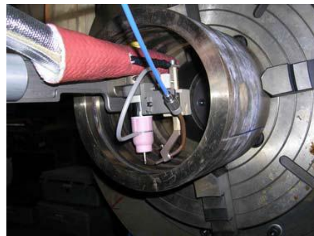
Автомат для восстановления антикоррозионной наплавки (будет изготовлен по ТЗ ОАО НПО «ЦНИИТМАШ»)
