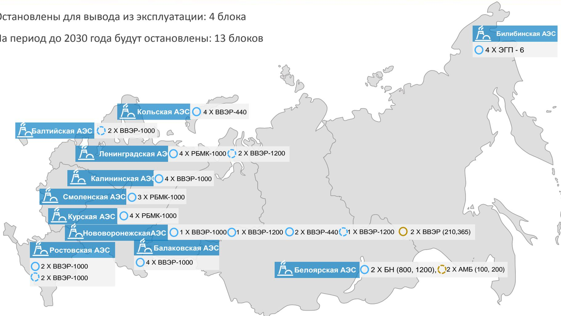
В стадии строительства Эксплуатация Вывод из эксплуатации В стадии останова
