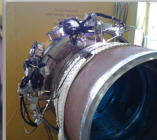
**Комплекс оборудования для автоматизированного дистанционного ремонта трубопроводов КМПЦ АЭС РБМК**
