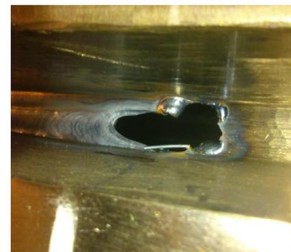
Прожег сварного шва при выполнении корневых проходов
