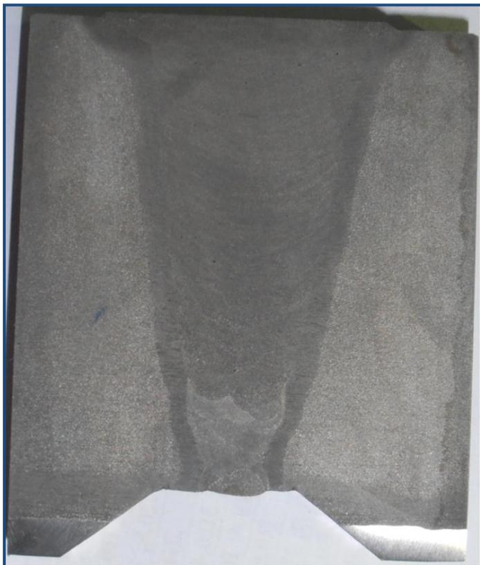
Макроструктура сварного соединения
