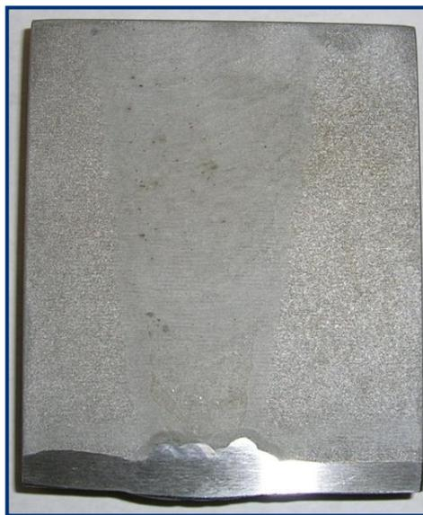
Макроструктура сварного шва
