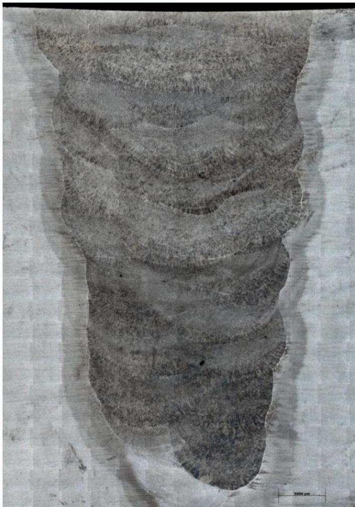
Макроструктура сварного соединения, выполненного РДС
