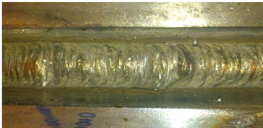
Внешний вид сварного соединения выполненного РДС
