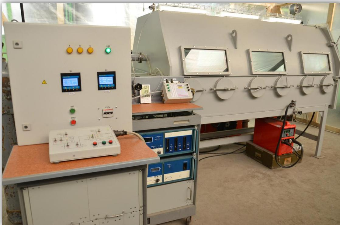
**Камера для сварки и наплавки элементов конструкции самолетов из титановых сплавов в контролируемой атмосфере**
