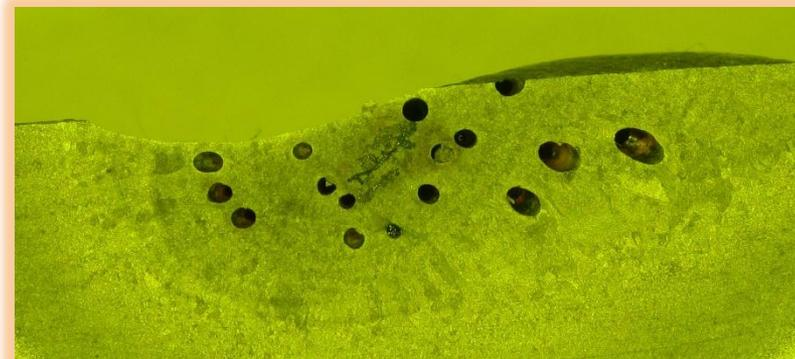
Металлографический макрошлиф при сварке в непрерывном режиме (x10)
