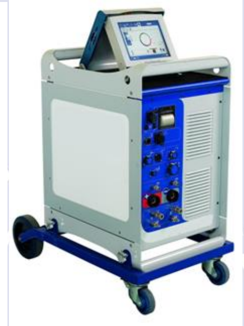
Источник питания со встроенным ПК для программирования и записи параметров режима
