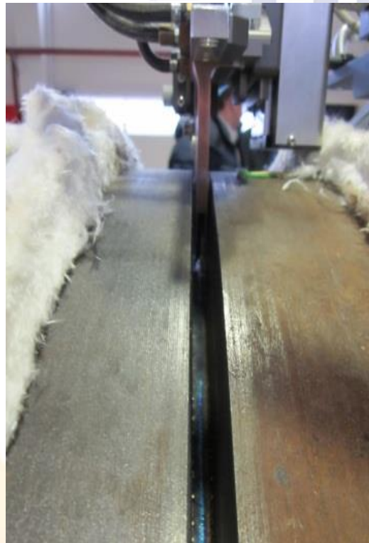
Горелка для сварки в узкую разделку
