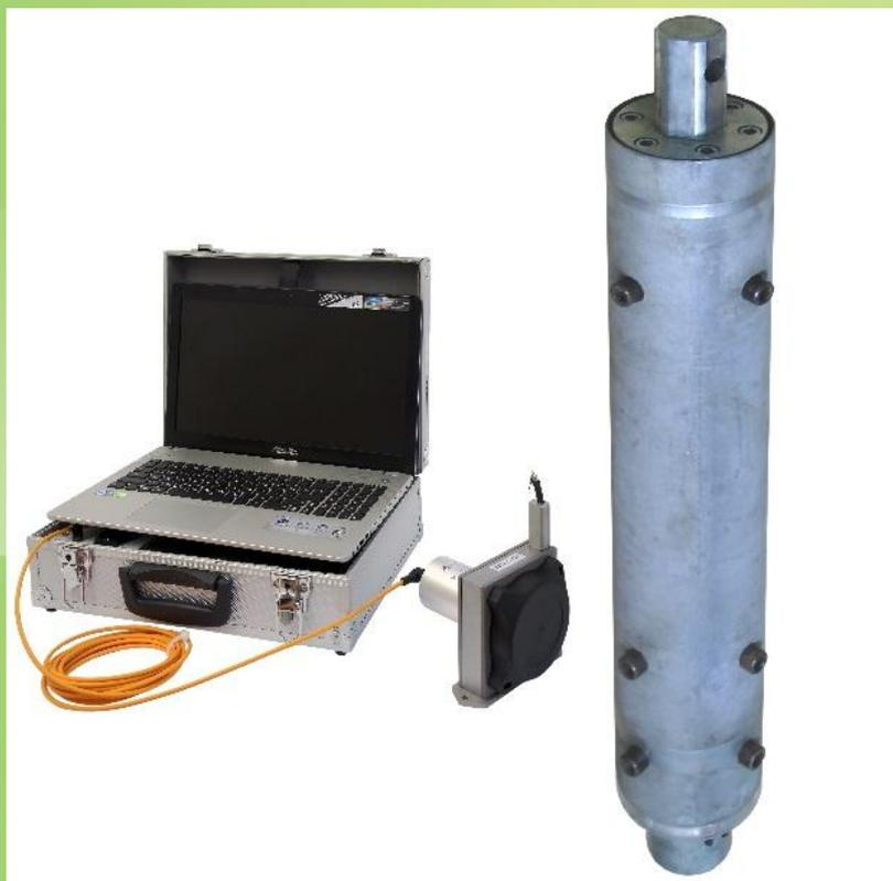
Комплект для испытаний методом бурового зондирования
