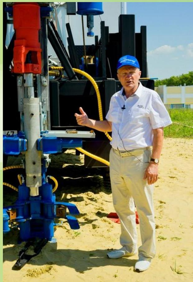
Соединение зонда с приводом бурового станка
