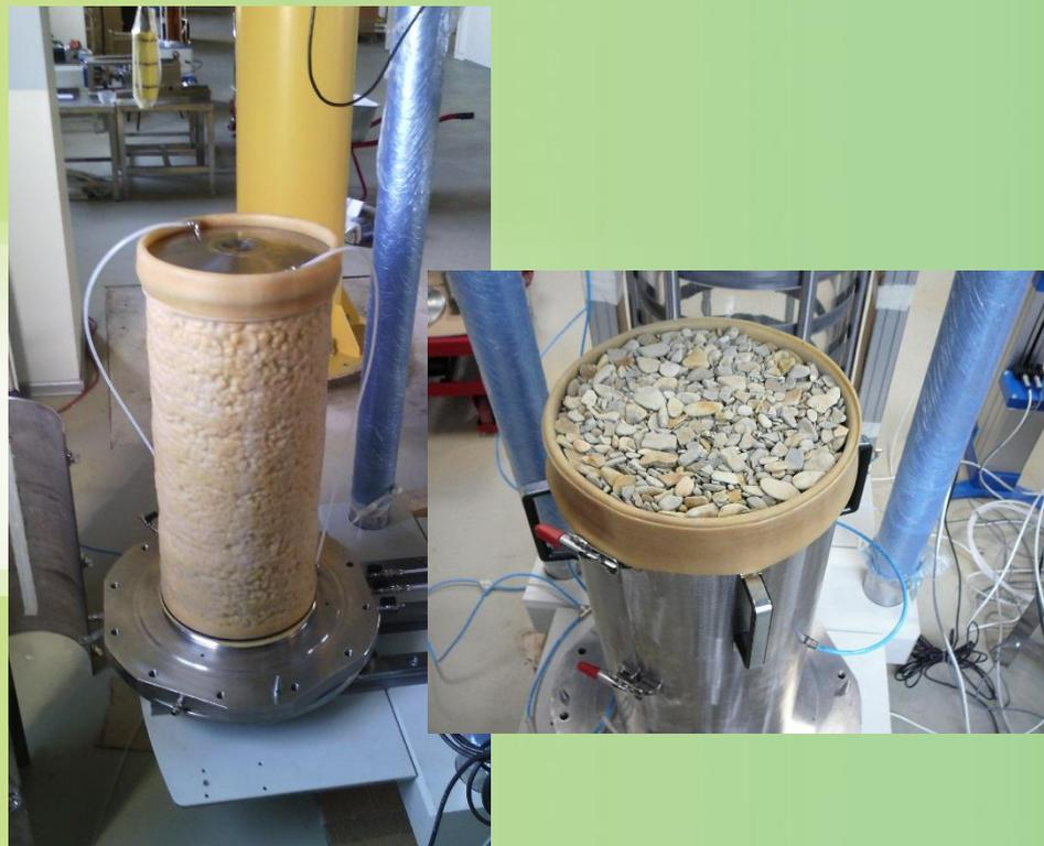
Образец диаметром 300 мм
