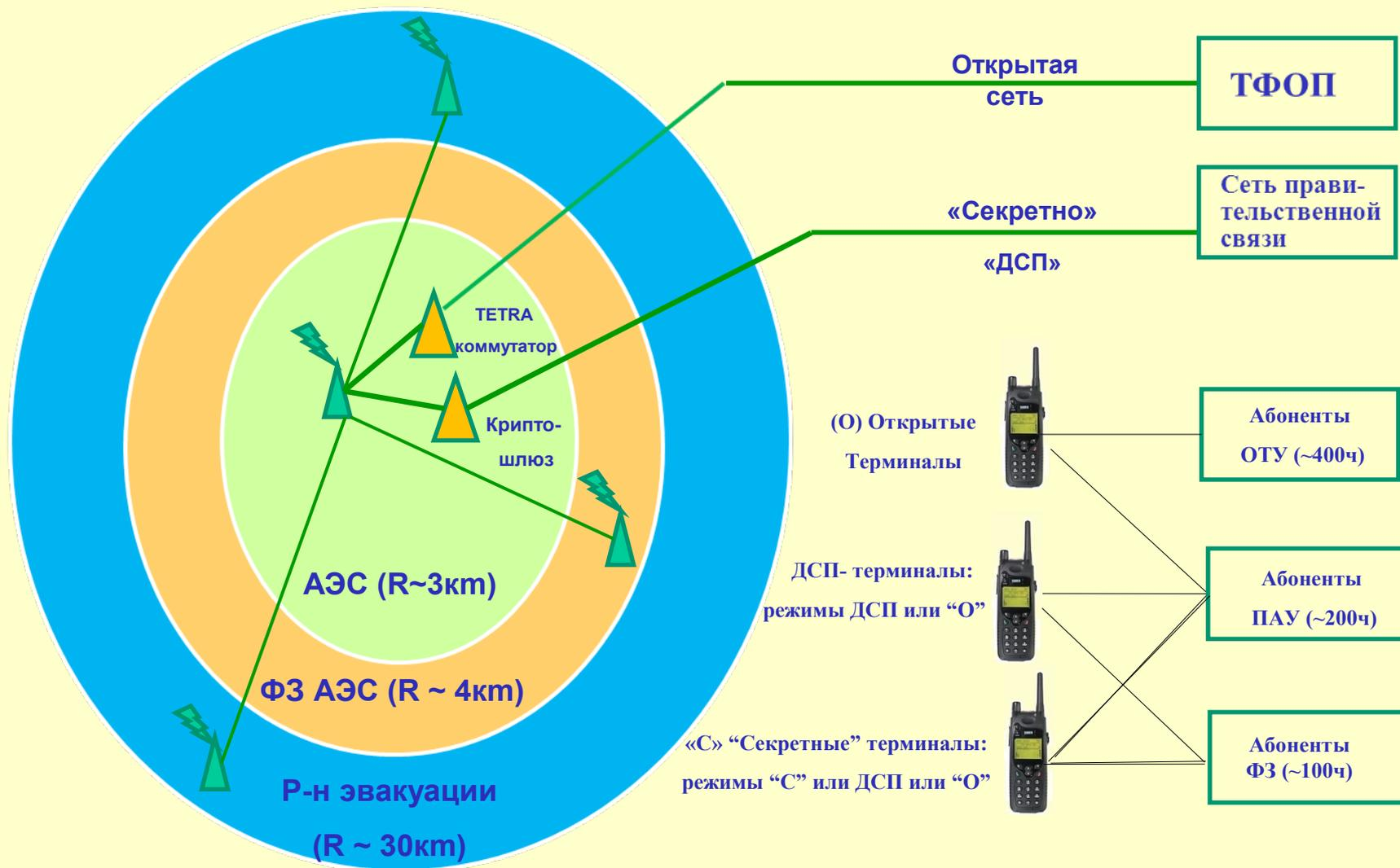
3-5 БС ТЕТРА для покрытия ~700 абонентов АЭС (?DMR)
