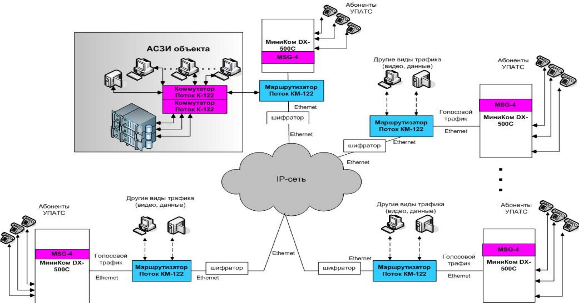
1. Разделение потоков управления и данных на коммутаторах Поток защищает от НСД и НДВ систему управления ИТ-системы.
