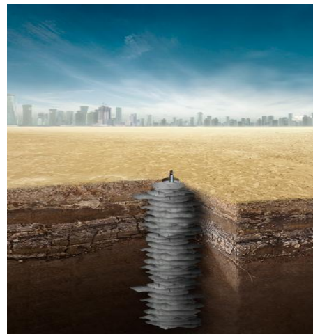
5. Готовая грунтоцементная свая
