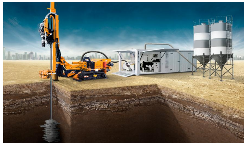
3. Подъем бурового снаряда с вращением и одновременной подачей цементно-водного раствора.
